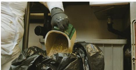
**5** 用油灰刀刮各个侧面、盖子和挡板，尽可能多地去除油脂。然后将其放入防水容器中。
